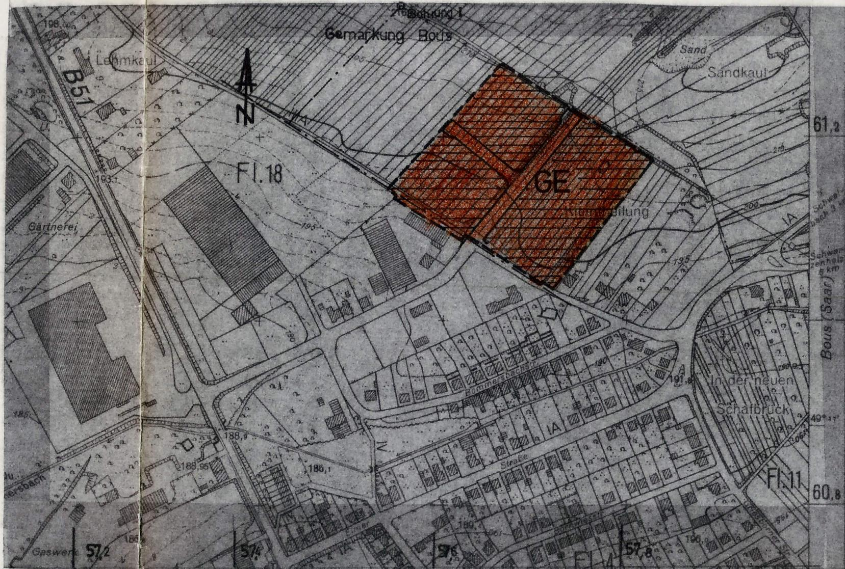
23. Mit Geh-, Fahr- und Leitungsrechten zugunsten der Allgemeinheit eines Erschließungsträgers oder eines beschränkten Personenkreises belastende Flächen siehe Plan (schraffierte Fläche), sowie Schutzbereich für die HS-Leitung
