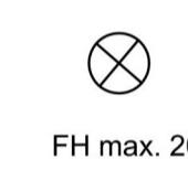
Hauptversorgungsleitung unterirdisch (Gas) mit Schutzstreifen
