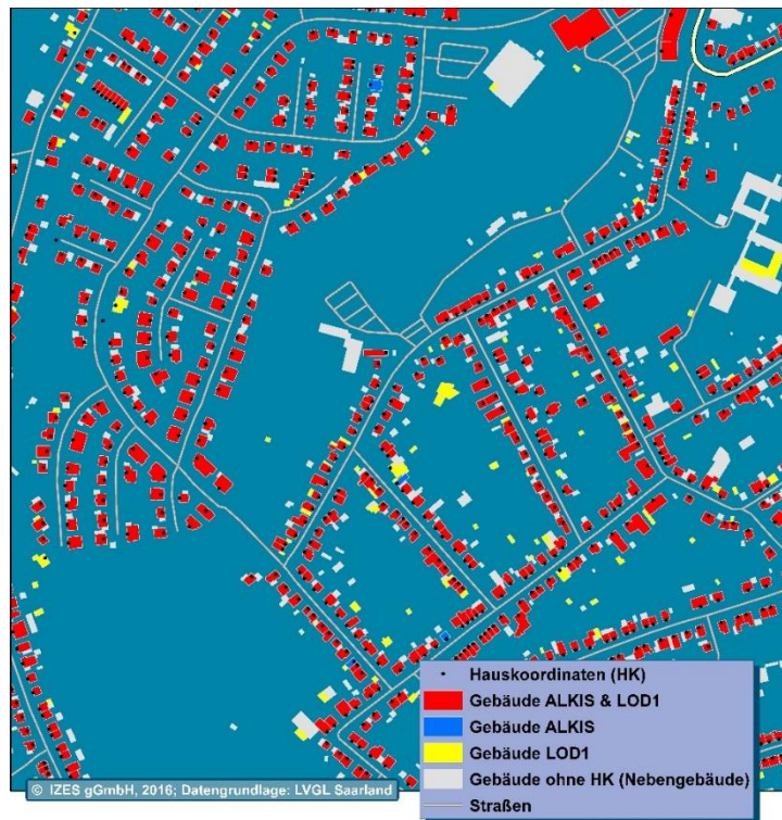
Abbildung 1: Überlagerung des ALKIS-Datensatzes und des 3D-Gebäudemodells
