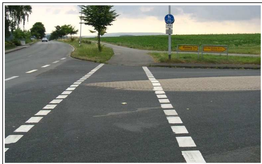
Bild 6-38: Nicht abgesetzter Radweg mit Vorrang an einer Einmündung
