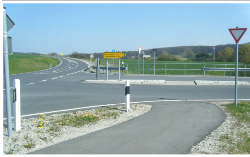
Bild 6-39: Weit abgesetzter Radweg mit Wartepflicht an einer Einmündung
